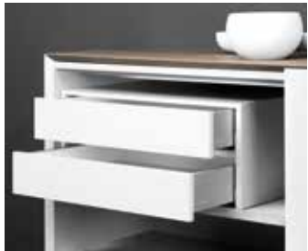
Ein optionales Modul, bestückt mit 2 Schubkästen, kann ergänzend eingebaut werden. Der Einbau ist auch nachträglich möglich. Mindestabstand zwischen der Oberkante des Schubkasten-Moduls und der Unterkante des Korpusoberbodens 6,6 cm.
