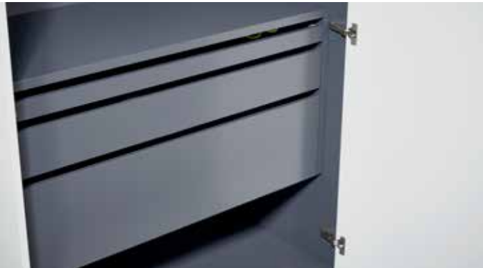
Niedriger, mittlerer und hoher Innenschubkasten. Oben mit Griffuge. interlücke exklusiv sind die grafischen Innenschubkästen mit nur 0,4 cm starken Aluminiumseiten im warmen cashmirgrau. Die Unterflur-Vollauszüge sind mit der neuesten Technik und gedämpftem Selbsteinzug ausgestattet. Maximal bis 17 kg belastbar
