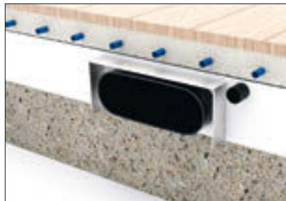
Flachkanal in der Trittschalldämmung mit Bewehrung
